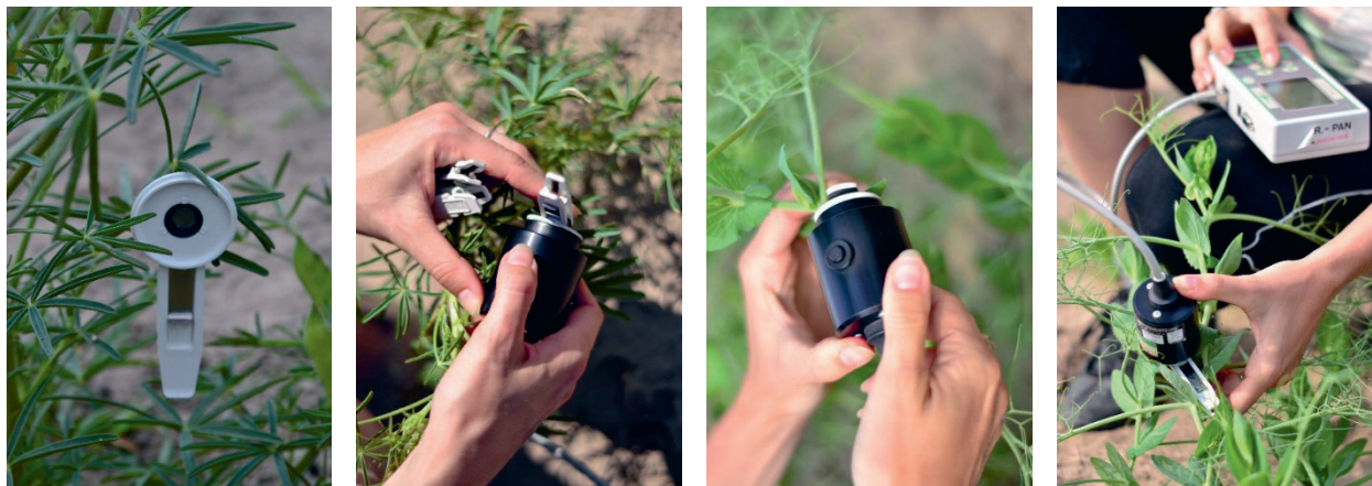
Rysunek 10. Pomiary parametrów fluorescencji chlorofilu za pomocą fluorymetru HANDY PEA.
